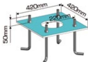
Le gabarit reste en place de niveau et doit reposer entièrement sur massif béton. Entraxe tiges de scellement 220 x 220 mm.
