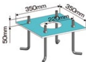
Le gabarit reste en place de niveau et doit reposer entièrement sur massif béton. Entraxe tiges de scellement 220 x 220 mm.
