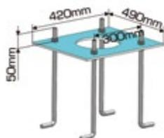
Le gabarit reste en place de niveau et doit reposer entièrement sur massif béton. Entraxe tiges de scellement 300 x 300 mm.
