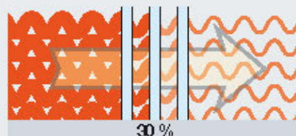
Triple vitrage DURATEC en option Amélioration de l'isolation thermique jusqu'à 30 % par rapport au double vitrage de 16 mm
