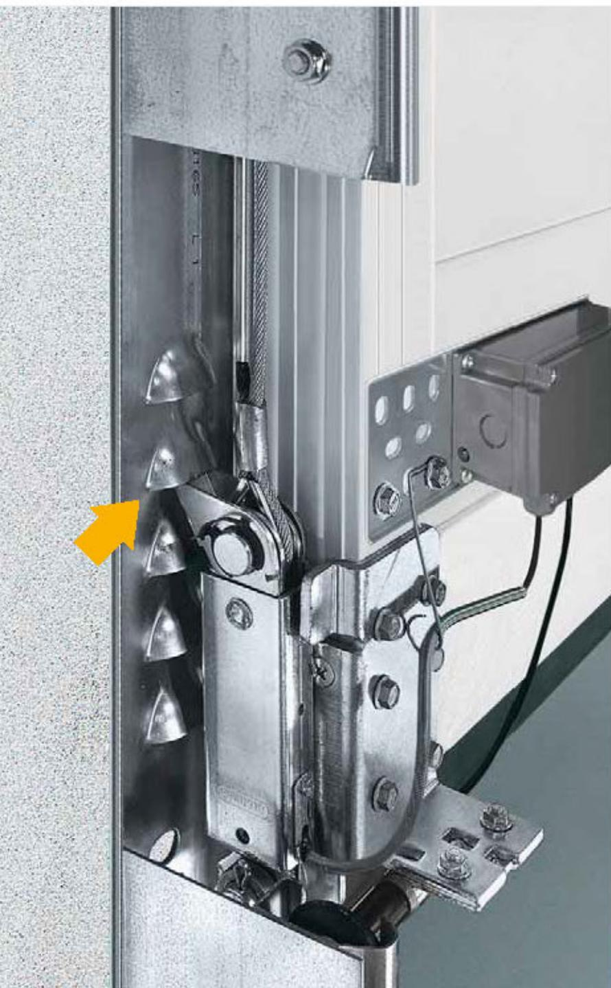
En cas de soulèvement de la porte, le crochet de verrouillage de la sécurité anti-relevage s'enclenche automatiquement.
